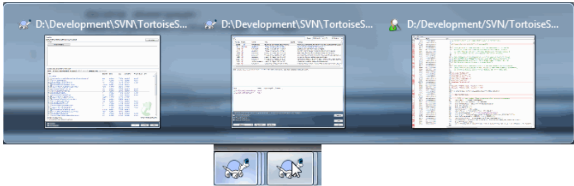
Figure 4.97. Barre des tâches avec groupement par dépôt
